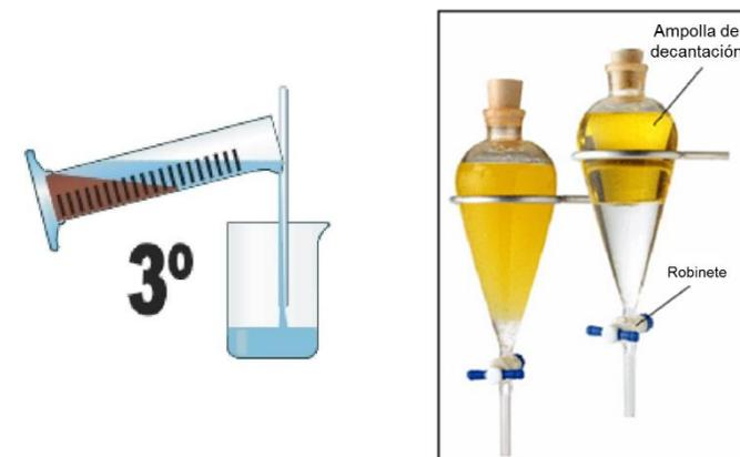
Paso por encima del borde o canto de un recipiente del líquido sobrenadante proveniente del proceso de sedimentación y cuyo contenido en sólidos es bajo o nulo.
