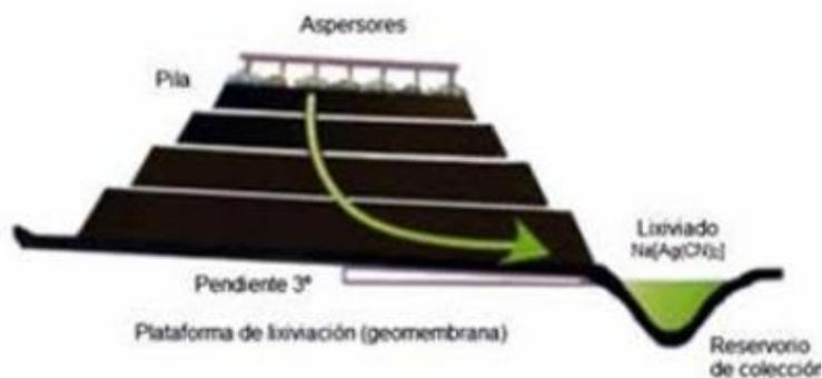
Separación de sistemas heterogéneos sólidos, en el que uno de los componentes es soluble en determinado solvente, mientras que los otros no lo son. Por filtración se separa el sólido de la solución y se rescata el componente soluble por evaporación del solvente o destilación.
